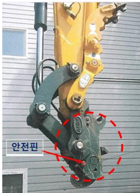
<그림 9> 퀵 커플러 안전핀 설치 상태
